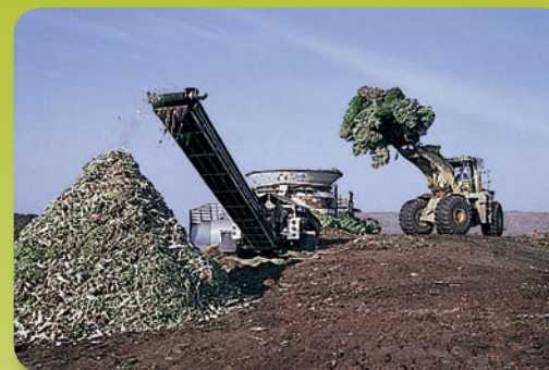
Los desechos de jardín se trituran y con ellos se produce mantillo y composta en el Relleno Sanitario Miramar.
